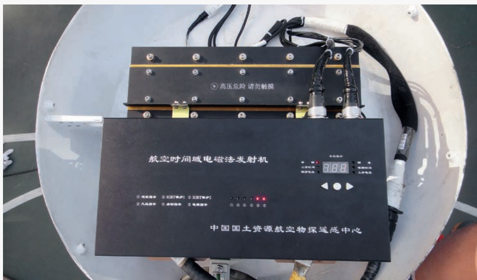
1 我国自主研发的时间域直升机航空电磁勘查系统发射机 2 内蒙古赤峰飞行一瞬
