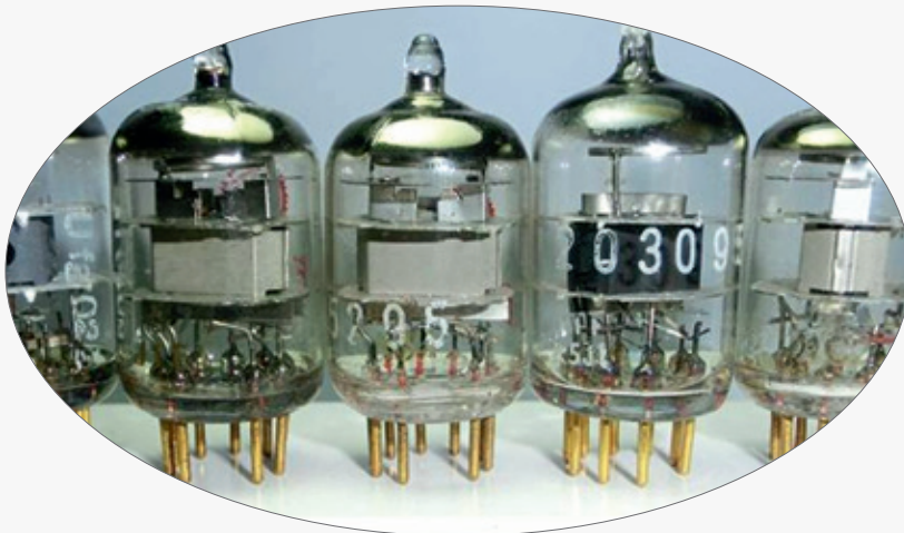
> 涂有锆粉的电子真空元器件
