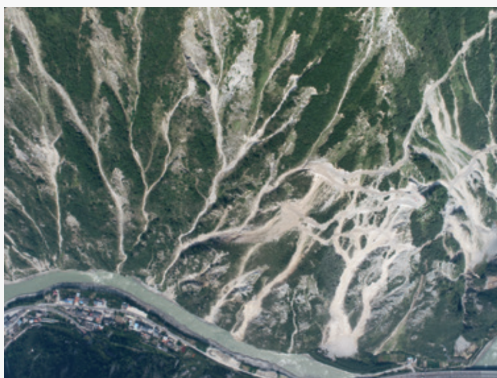
＞ 2024 年，岷江流域震后残留滑坡与公路切坡形成坡面泥石流共存
